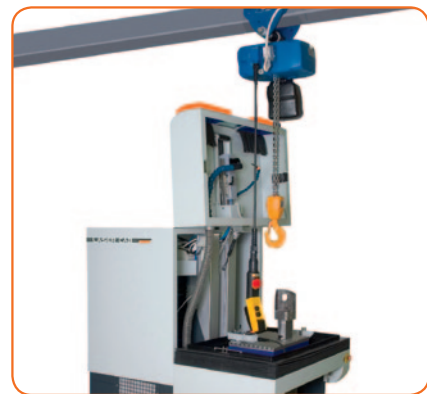
Durch aufklappen der Abdeckungen kann z.B. mit einem Schwenkkran das Positionieren von schweren Bauteilen erfolgen.
