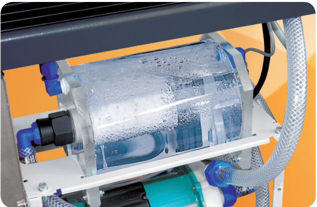
Das interne Wasser-Luft Kühlsystem sorgt für eine homogene Strahlqualität.
