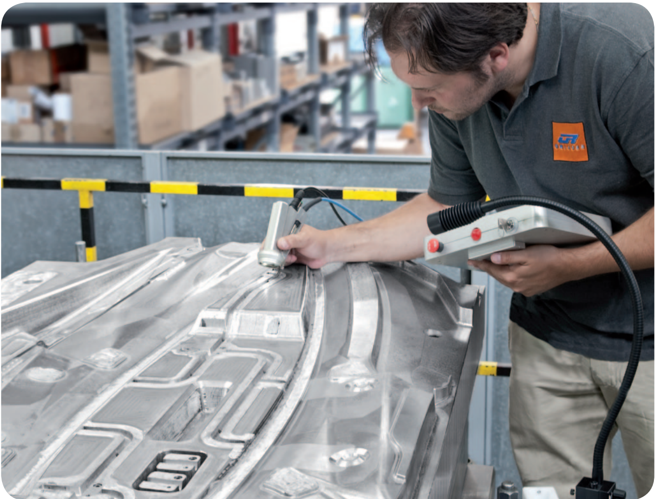
Reparaturschweißen an einer Spritzgussform
